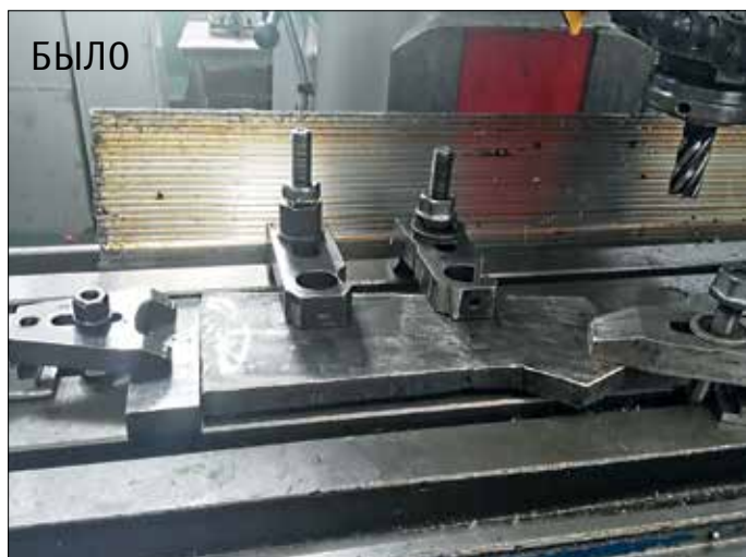
Пример быстрой переналадки фрезерного станка с ЧПУ
