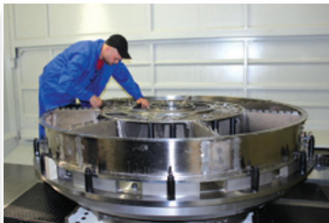
Механосборочный цех ОДК-УМПО. Обрабатывающий центр Starrag для обработки крупногабаритных узлов
