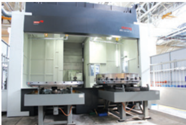
Механосборочный цех ОДК-УМПО. Обрабатывающий центр Starrag для обработки крупногабаритных узлов
