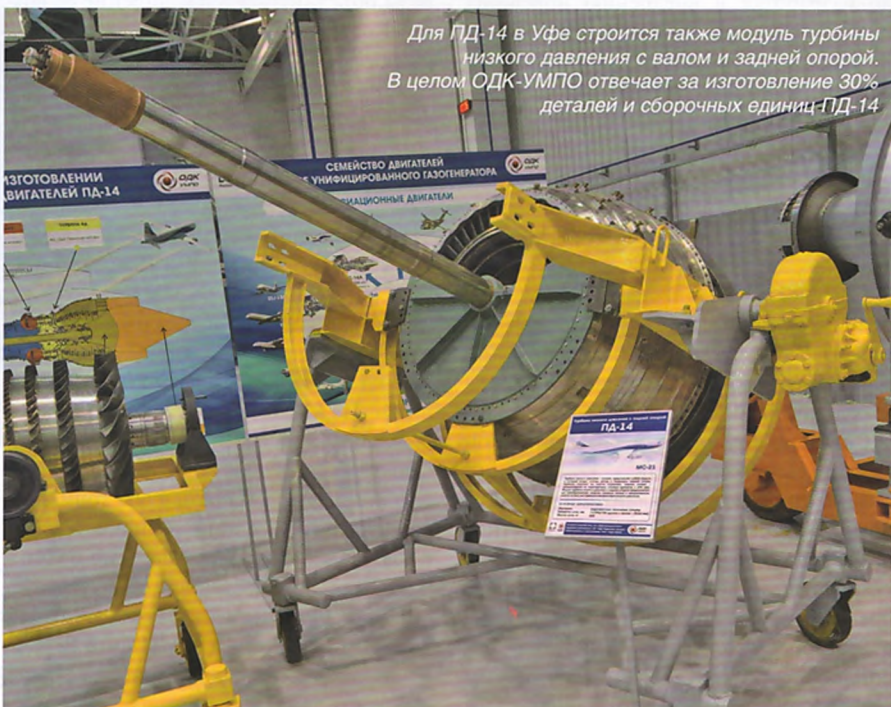
Вентилятор ПД-14 с полыми титановыми рабочими лопатками уфимского производства
